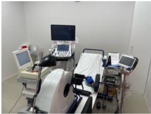
図6 エルゴメータ運動負荷心エコー 検査時の配置 (国立循環器病研究センター)
